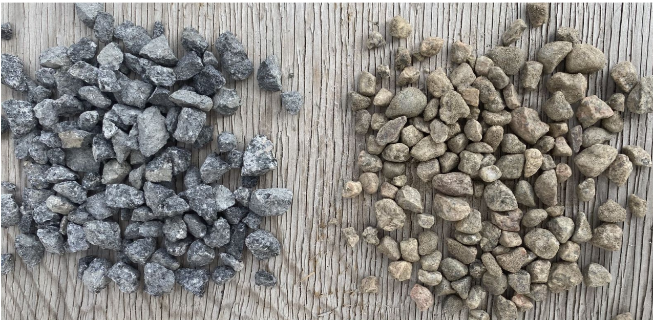
Kuvio 1. Vasemmalla kalliosta murskattuja kiviä & oikealla luonnonsorasta seulottuja kiviä
