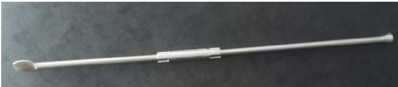
Kuva 4. THR+ VLR+ TS- tiilisiteen osa valmistusvaiheessa (Lankarakenne Oy, 2018)
