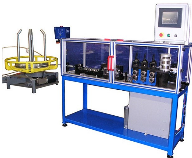
Kuva 16. Automatisoitu langansyöttölaite (Novo Precision, s.a)
