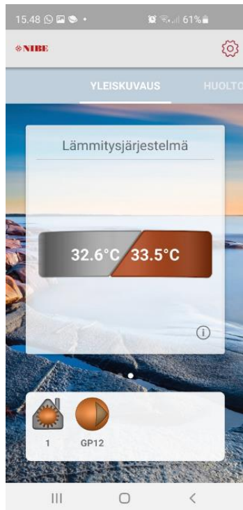
Kuva 23. Uplink sovelluskuva. Lämmitysjärjestelmän meno- ja paluueden lämpötilat. Lämmitys ja LJ-pumppu päällä.
