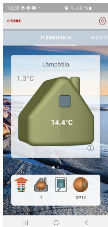
Kuva 21. Uplink sovelluskuva. Lämmitys, LJ-pumppu ja kompressori päällä.
