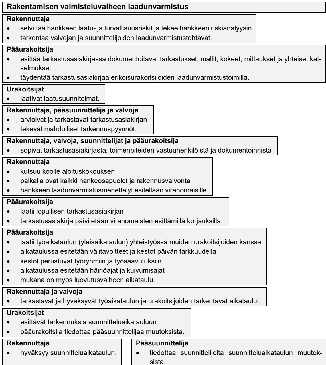
Kuvio 24. Rakentamisen valmisteluvaiheen laadunvarmistus (Ratu S-1224, 2009).
