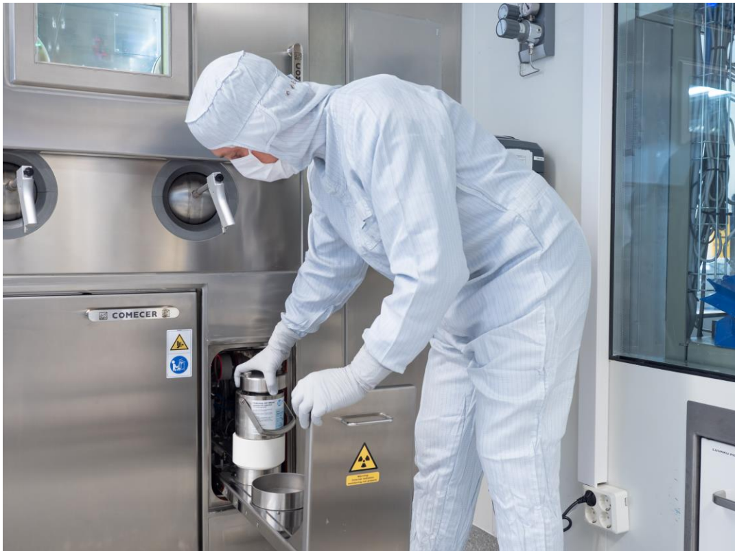
Kuva 10. Annostelukaapissa annosteltu radiolääkeainetuotepullo siirretty lyijykuljetuslinnaan.
