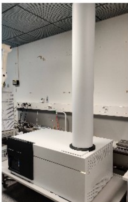
Kuva 4. Agilent Technologies 6545 Q-TOF LC/MS analyysilaitte. (kuva Marjo Mauriala).
