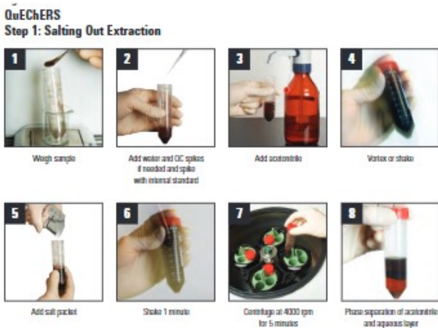
Kuva 1. QuEChERS-tekniikan vaiheet (8 vaihetta)(2).
