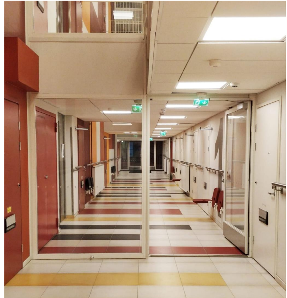
Kuva 33: Korttelin käytävillä on mahdollista levähtää ja istuskella, seinille kääntyvillä penkeillä. Penkeillä voisi ehkä viipyilläkin käytävällä, jos olisi näkymiä esimerkiksi ulos, jolloin voisi seurata pihan toimintaa. Nyt voidaan pohtia miksi käytävälle jäisi istuskelemaan. Lattianpinnassa vaihtuvat värimaailmat saattavat luoda vaikutelmia tasoeroista ikääntyneille ja heikkonäköisille. Visuaaliset yhteydet muihin kerroksiin ovat mahdollisia. (Sara Piippo.)
