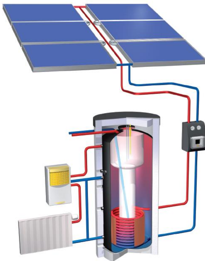
Kuva 7 Aurinkolämpöjärjestelmän toimintaperiaate (Wagner Solar GmbH 2012)
