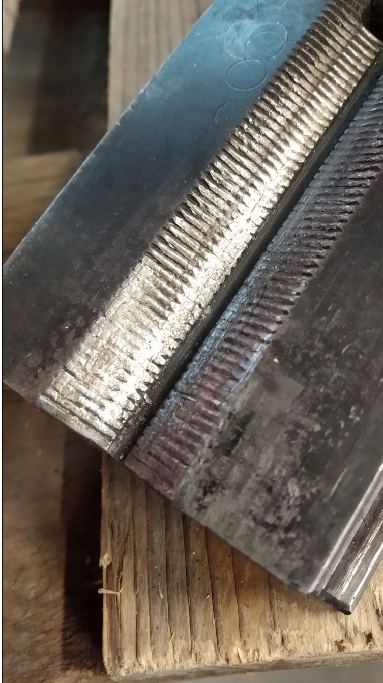
Kuva 4. Vauriot leukapalan pinnassa.
