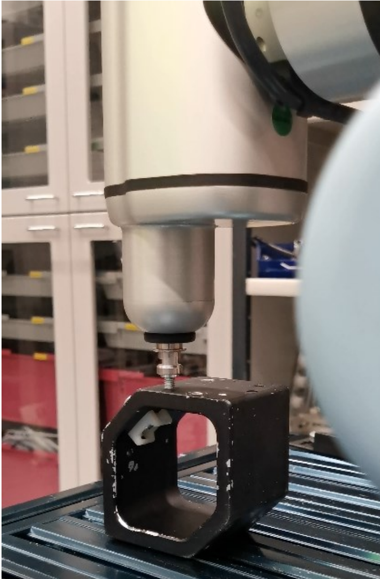
KUVA 6. OnRobot -ruuviväännin testissä Oamkin konelaboratoriossa
