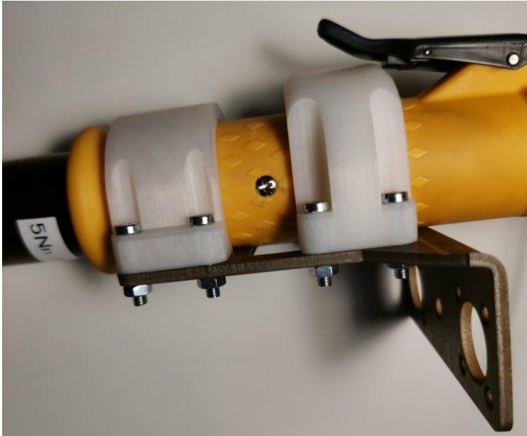
KUVA 31. Atlas Copco EBL55 -ruuviväännin kiinnitettynä teräslevyyn.
