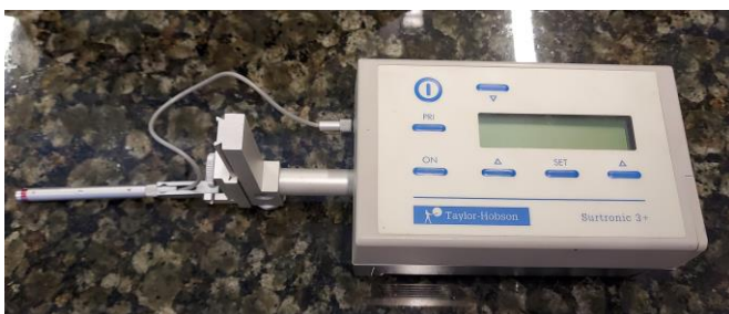
Kuva 21. Taylor-Hobson Surtronic 3+ pinnankarheusmittari.
