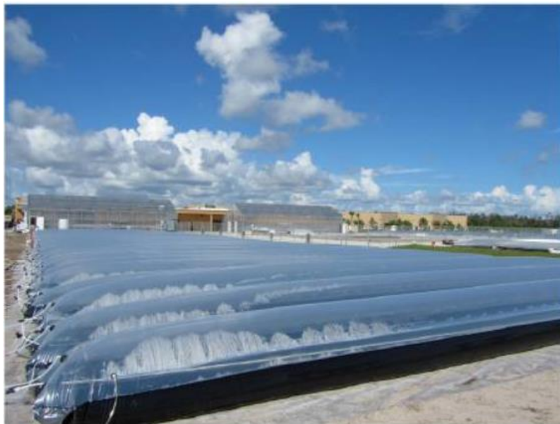
Kuva 7. Lumian AGS4000-viljelyraitkaisussa etanoli/vesi kondensoituu fotobio-reaktorin seinille ja valuu poistoputkia pitkin talteen [5].
