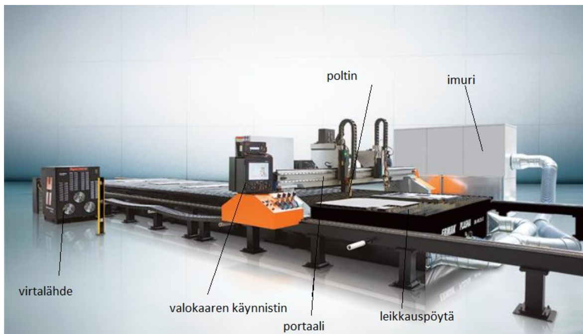
Kuva 11. Plasmaleikkauslaitteisto (Hypertherm 2020).
