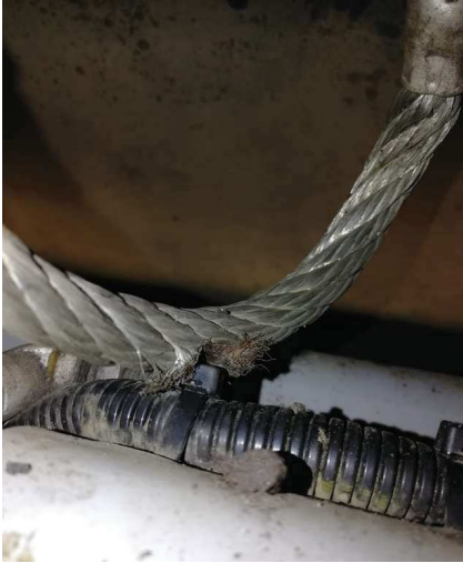
KUVA 17. Nippusiteen lukon rikki hankaama maadoituspunos
