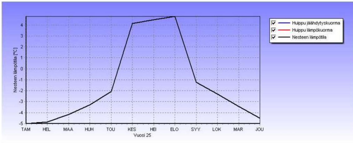
KUVA 12. Nesteen keskilämpötilan käyttäytymisen simulointitulokset EED-ohjelmasta jäähdytyksellä
