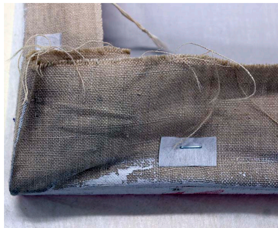
Kuva 46. Trevira Taft -polyesterikangas kiinnitettiin irtovuoraukseksi maalauskanan alle.
