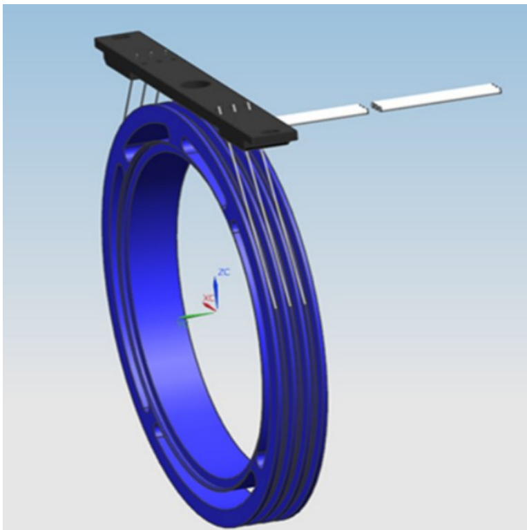
Kuva 5. Liukurenkaan signaalien kontaktipinnat [6, s. 2.]
