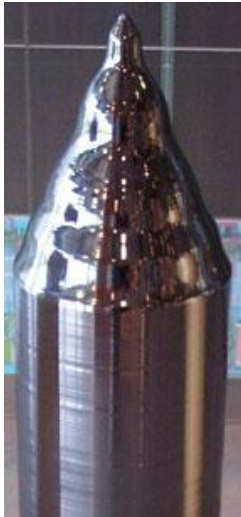
Kuva 3. Yksikiteinen piisylinteri (solarserver)
