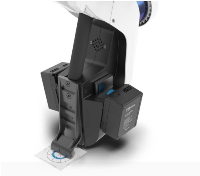
Kuva 11. Kiintopisteen mittaaminen maasta. Keilain lasketaan mittauksen aikana hetkeksi mahaan kiintopisteen päälle. [24]
