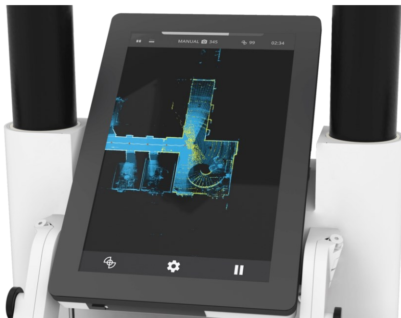
Kuva 4. NavVis M6:n mobiilikeilausjärjestelmä. Keskellä on keltainen viiva, joka on laitteen kanssa kuljettu reitti vasemmalta oikealle. Samalla kulkiessaan laite kartoittaa ympäristöä eli hyödyntää SLAM-menetelmää. [12]
