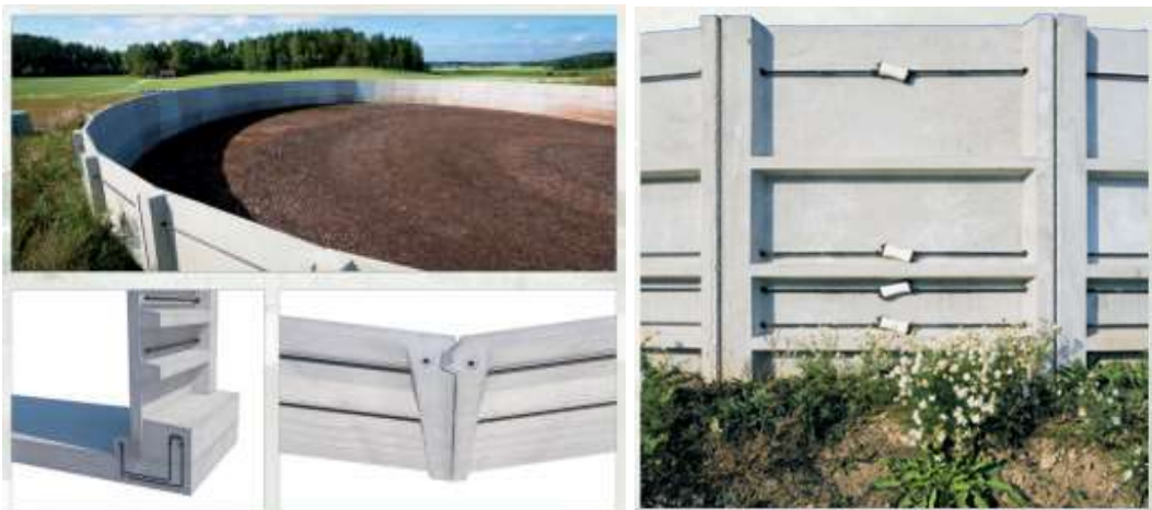
KUVA 4. Jälkijännitetyistä elementeistä rakennettu lietesäiliö, seinäelementin sijoitus pohjalaatalle, pystysaumarakenne sekä jännitysvalijerien jännityslukot (Acontank™ -Luotettava ja pitkäikäinen ratkaisu, isältä pojalle. 2020, 2)
