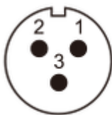
Kuva 8. SP13-liittimen napojen numerointi [14]
