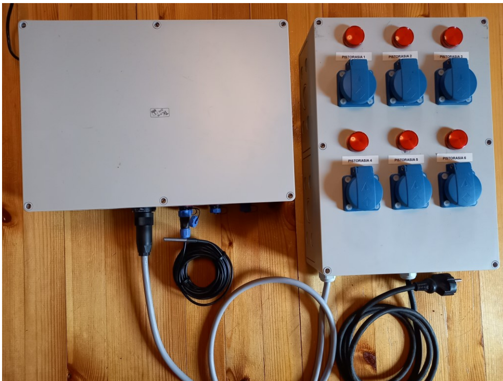
Kuva 3. Ohjainkeskus vasemmalla ja jakokeskus oikealla
