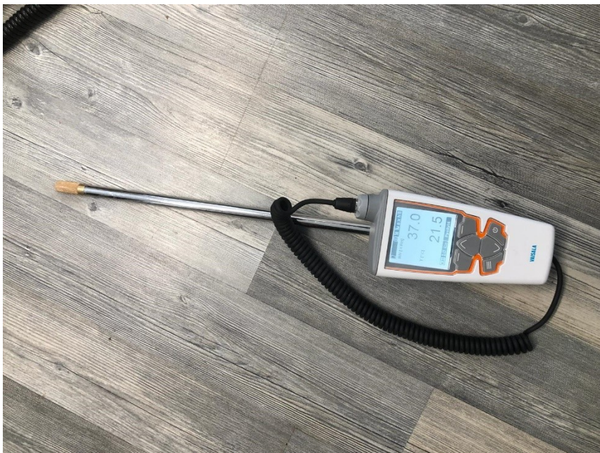
Kuva 4. Vaisala HM40, kosteus- ja lämpötilamittari
