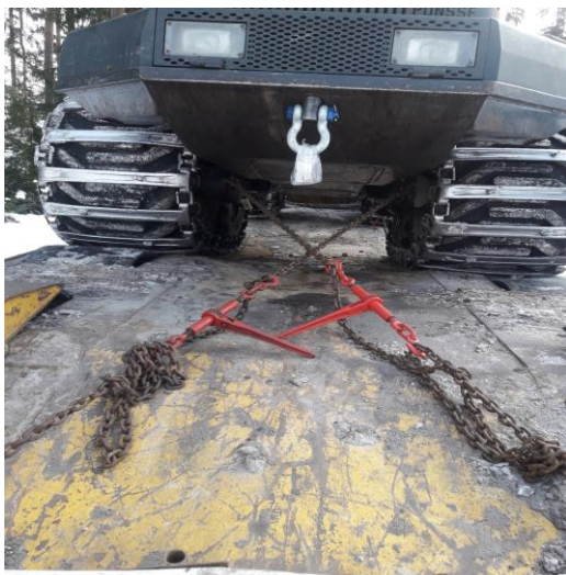
KUVA 1. Koneiden sitomisessa käytettävät ketjut ja vantit ovat esimerkkejä kuljettajan fyysisistä haasteista. Kuvassa ajokone lavetilla kirjoittajan sitomana.
