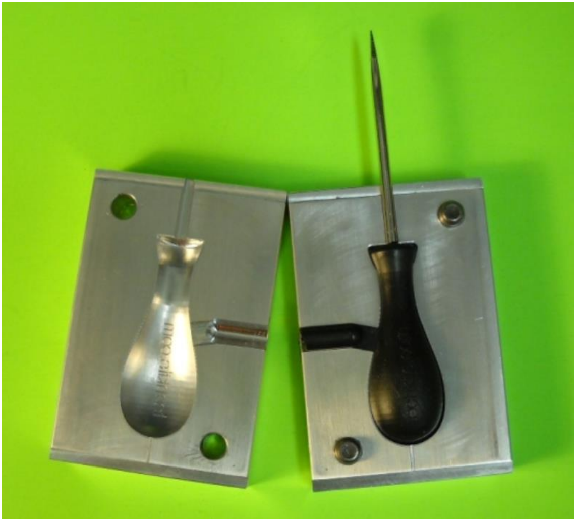
KUVA 6. Ruuvimeisselin kahvan valmistaminen ruiskuvalulla (Technologies n.d.)
