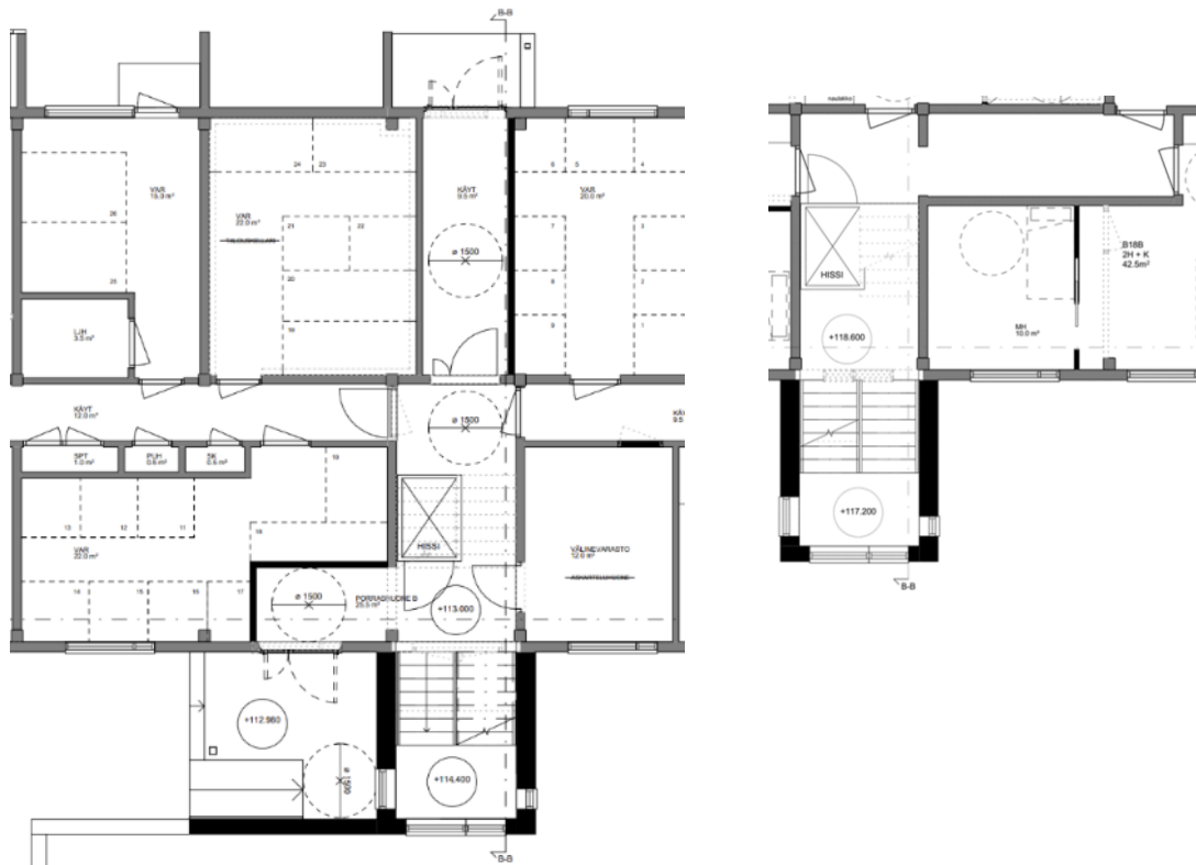
KUVA 20. Uusi porrashuone B pohjapiirustukset (Pirinen 2021, CC BY-NC-ND)
