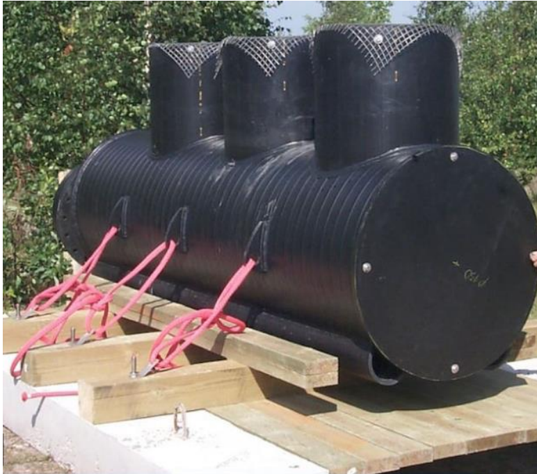
Kuva 7. Vesistön pohjaan ja imuputken päähän asennettava keruutukki [7].
