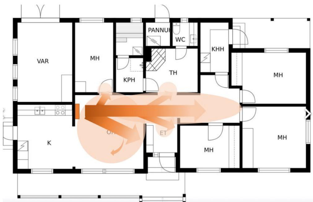
Kuva 5. Selkeä huonetila suosii ilmalämpöpumpun käyttöä lämmityksessä. Väliseinät ja monimutkainen talorakenne rajoittavat merkittävästi lämmön siirtymistä muihin huonetiloihin.
