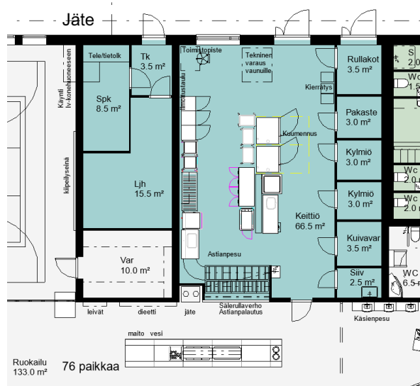
KUVA 26. Päiväkodin lämmityskeittiö (Miettinen 6/2021)
