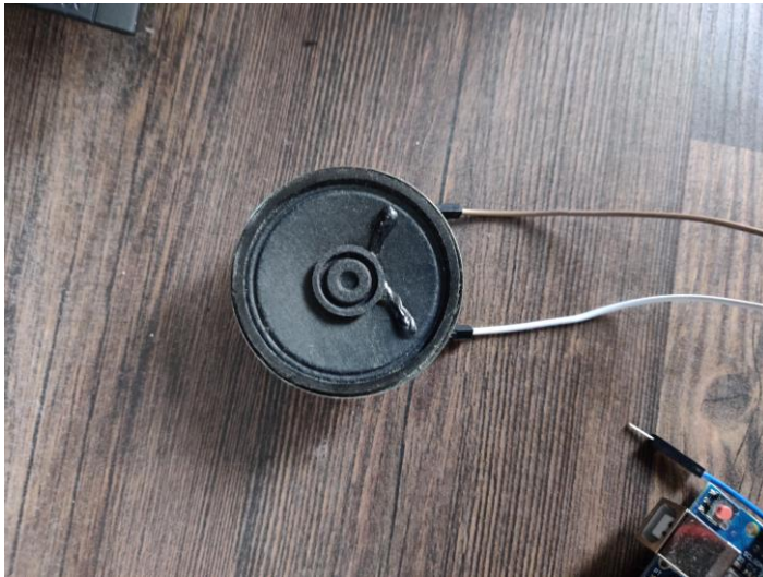
Kuva 8. Geneerinen kaiutnelementti merkkiäänien tuottamiseksi.
