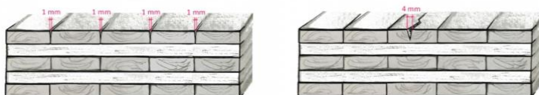
Kuva 2. Liimaustavan erot puun kuivuessa (Crosslam 2020b)
