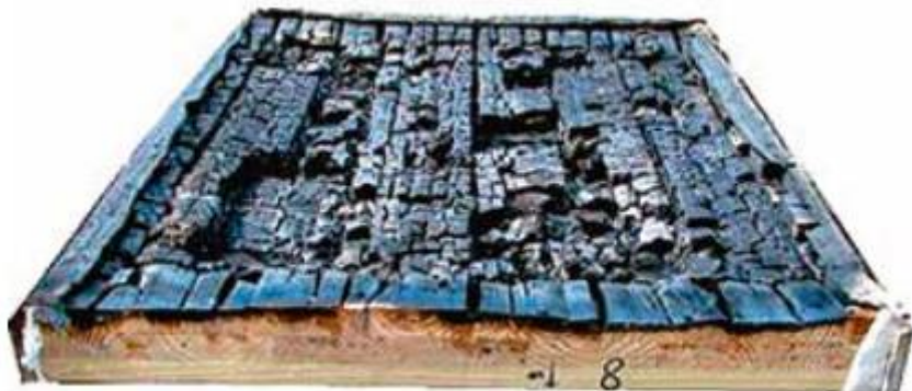
Kuva 18. CLT-levyn delaminoituminen (Puuinfo 2018, 81)
