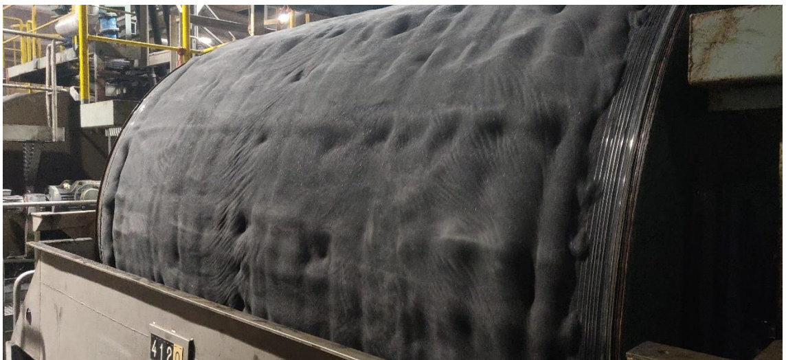
Kuvio 15. Muodostunut kakku suodattimen pinnalla.
