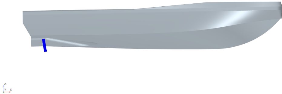
Kuva 15. Potkurien paikka aluksen sivulta katsottuna
