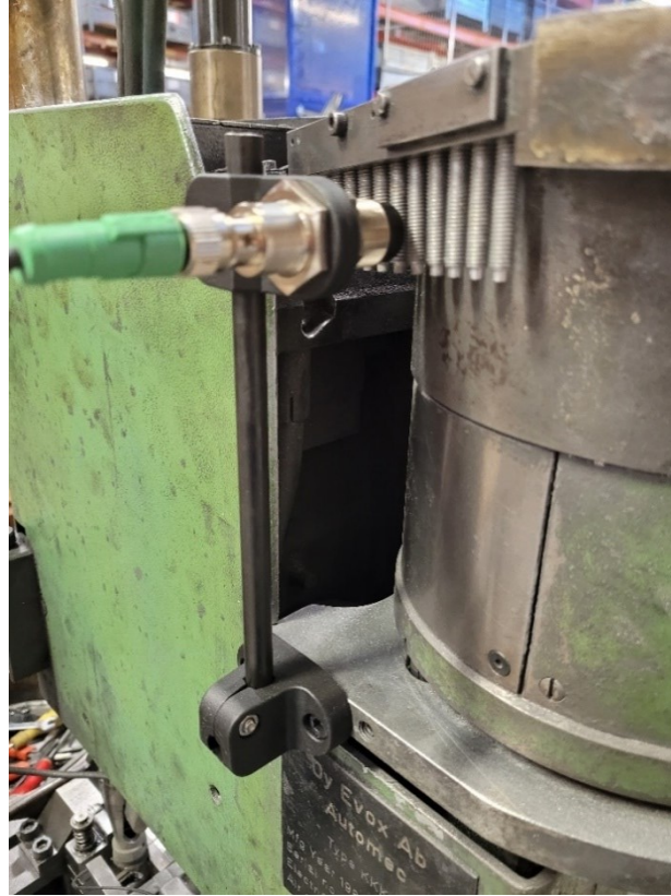
Kuva 14. Induktiivinen anturi tärymaljan kyljessä.
