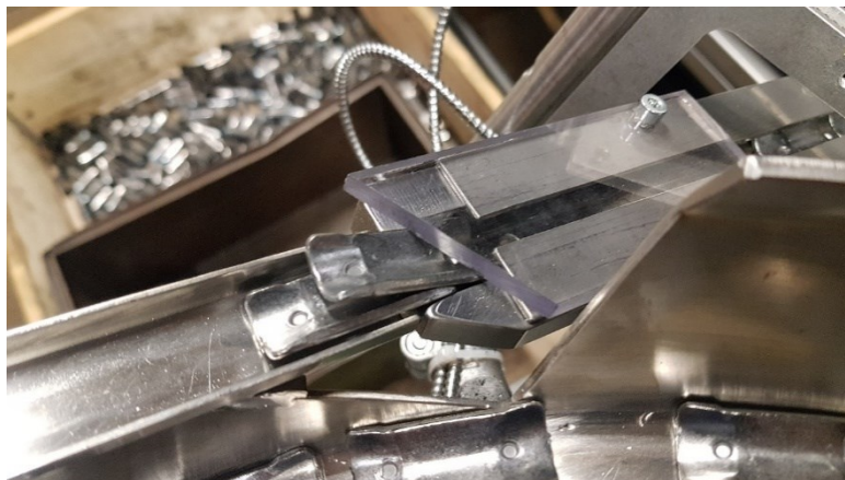
Kuva 6. Kaksi kappaletta kiilaantuneina syöttökanavan suulle.
