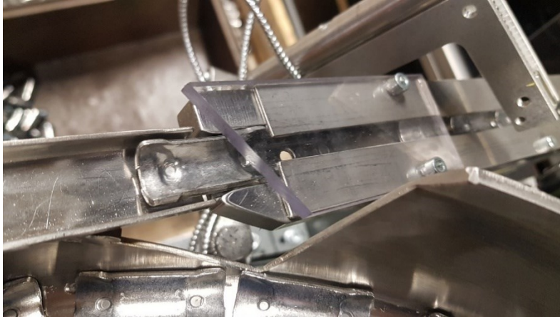
Kuva 5. Liian suuri kappale syöttökanavan suulle juuttuneena.
