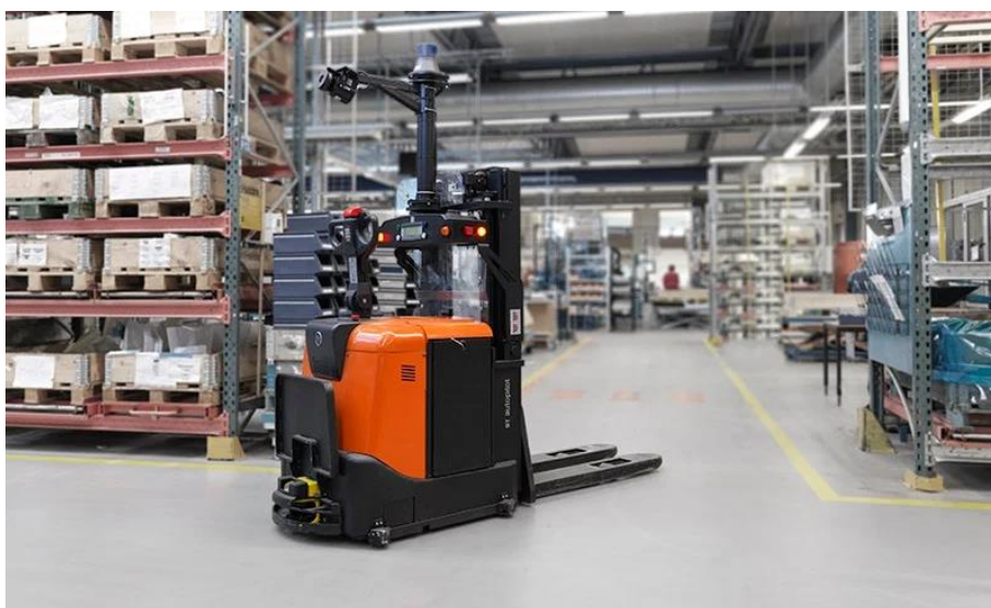
Kuva 3. Vihivaunu (AGV) (Toyota material handling 2021)
