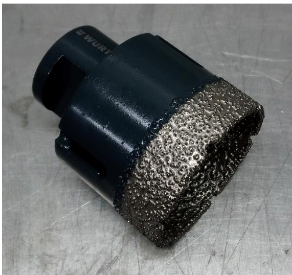
Liite 12. Testiryhmän 2 näytteiden porauksissa käytetyt timanttikuppiterämallit
