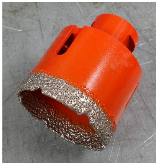
Liite 12. Testiryhmän 2 näytteiden porauksissa käytetyt timanttikuppiterämallit
