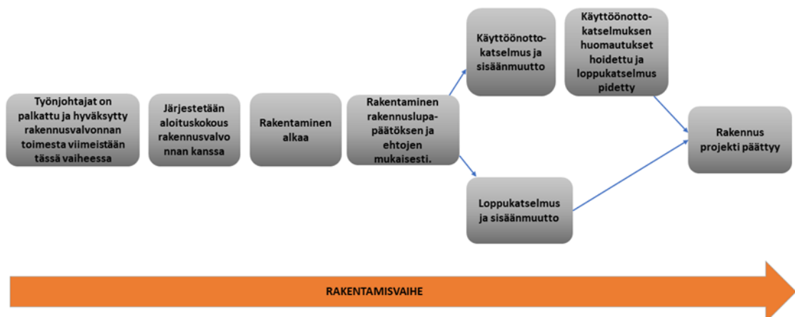
Kuvio 6: Rakennusprojektin rakentamisvaihe
