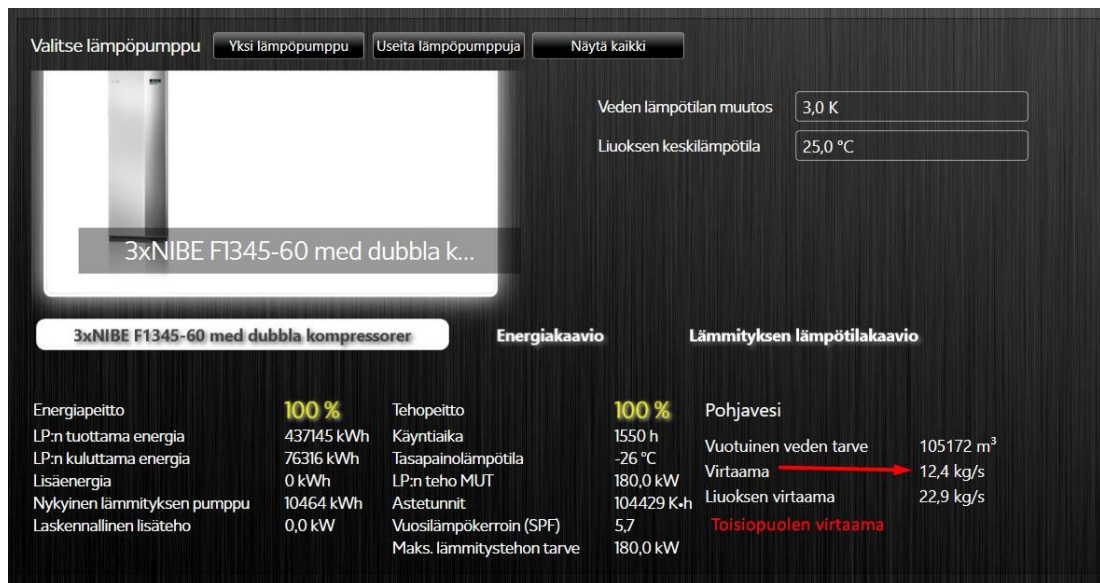
Kuva 13. NIBEn lämpöpumppujärjestelmän mitoitus. (Väätänen 2021).
