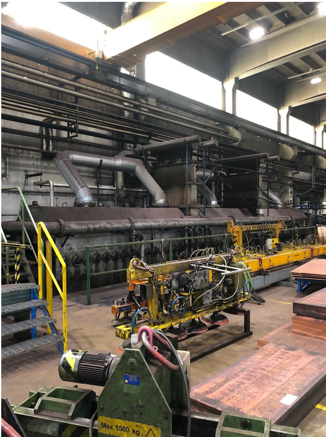
Kuva 2. Aurubis Finland Oy:n kuparivalssaamon jäädytystunneli.
