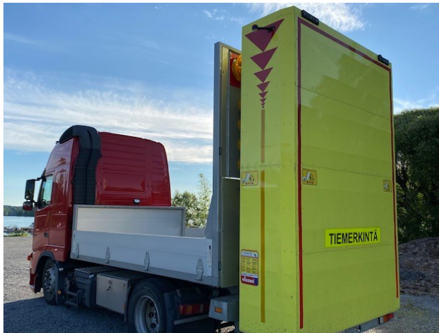
Kuva1: Törmäysvaimentimella (TMA) varustettu suoja-ajoneuvo kuljetusasennossa.
