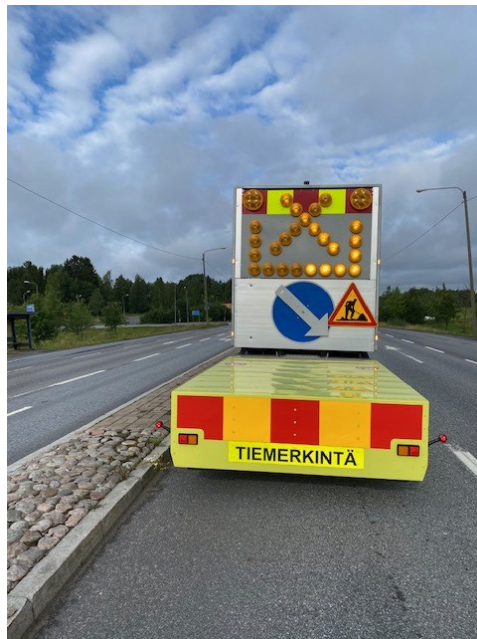
Kuva 3: Törmäysvaimentimella (TMA) varustettu tiemerkintäajoneuvo työmaalla
