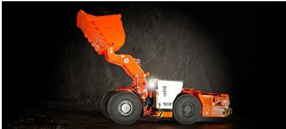
Kuva 1. LH410-lastauskone (Sandvik 2021a).
