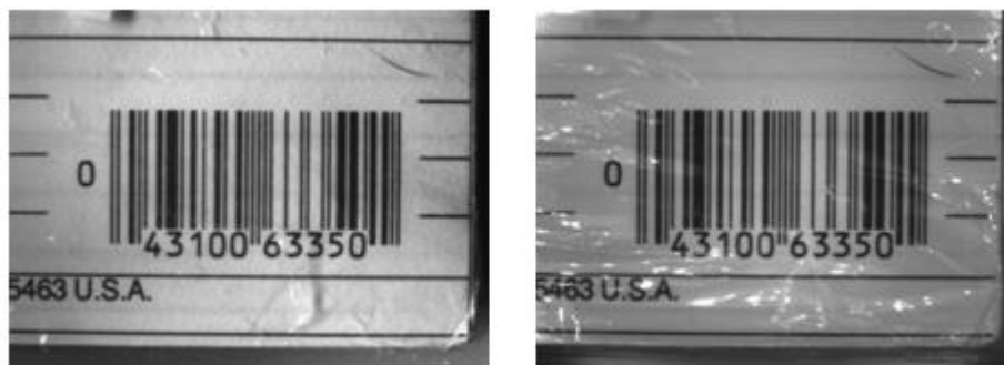
KUVA 3. Vasemmalla onnistunut valaistus, oikealla epäonnistunut (ni)
