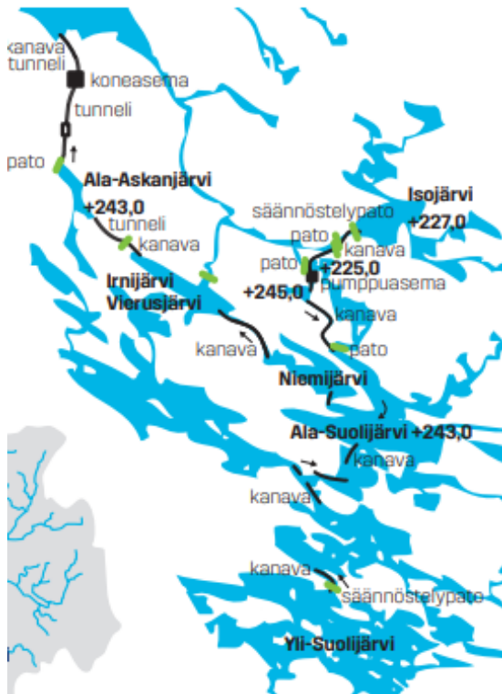
KUVA 18. Jumiskon voimalaitoksen säännöstelyjärvet (49, s. 3)
