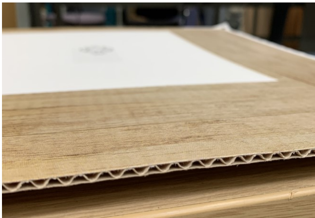
KUVA 22. Painettu C-aaltoinen aaltopahvi.
