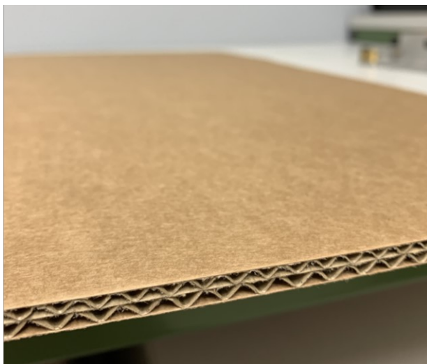
KUVA 19. BC-aaltopahvi, josta mitattiin washboard profiili kolme kertaa.
