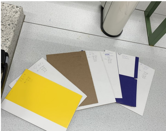
KUVA 25. Kosteusmittauksissa käytetyt pahvinäytteet Tehtaalta X.
