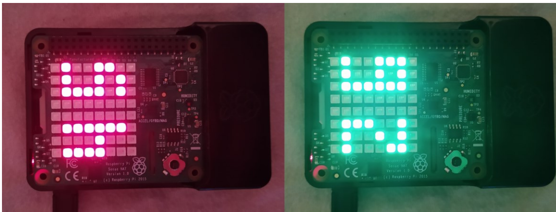
Kuva 14. Raspberry Pi -pienitietokone sekä kosteus- ja lämpötila-arvot SenseHatin näytössä.
