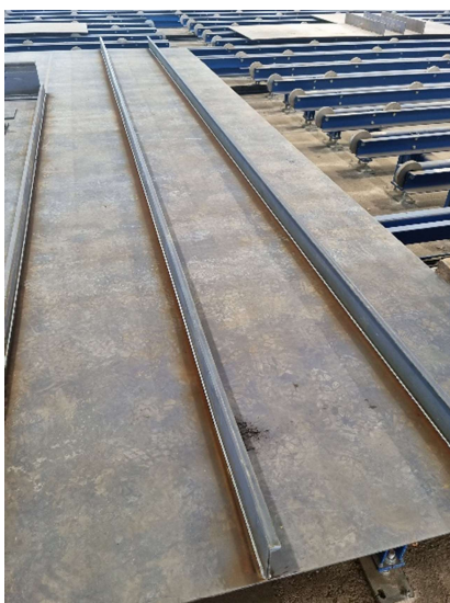
Kuva 9. Valmiita profiileja levyyn hitsattuna.
