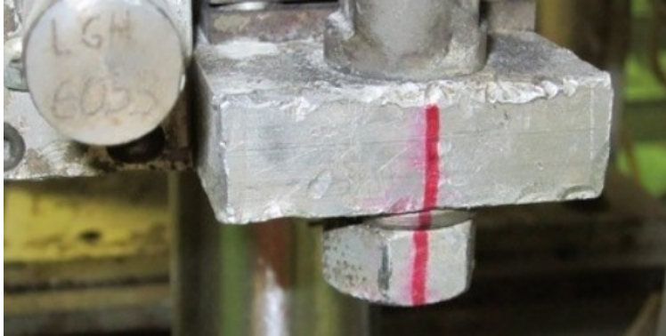
Kuva 6. Kiristyksen löystyminen on helppo havaita visuaalisesti merkintöjen liikkuaessa erilleen. [16.]
