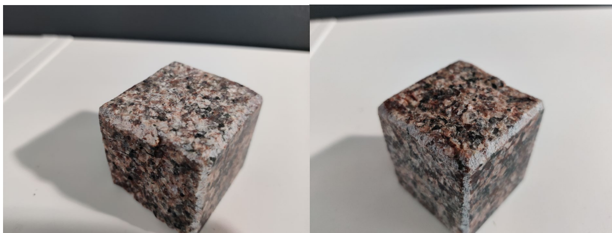
Kuva 7. Kuvassa vasemmalla poltettu ja oikealla ristipähakattu pintakäsittely.
