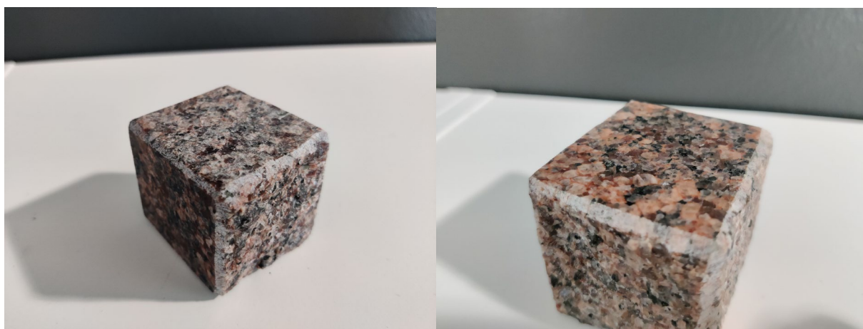
Kuva 6. Kuvassa vasemmalla sahattu ja oikealla kiillotettu pintakäsittely.
