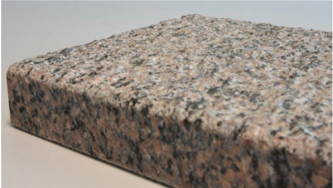
Kuva 9. Mallikuva karkeasta pintakäsittelystä, samaa pintakäsittelyä on käytetty Helsingin Keskuskadulla. Käsittely on tehty 4-hampaisella vasaralla.
