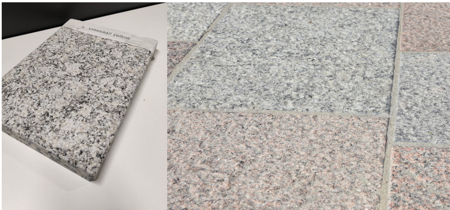
Kuva 3. Kuvassa vasemmalla luonnonkivilaatta, oikealla laatoitusta Helsingistä Erottajan aukiolta. Kuva: Tuomas Suni
