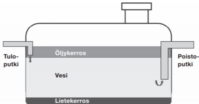
KUVA 14. Pelkistetty kuva II-luokan öljynerottimen toiminnasta. (Labkotec)
