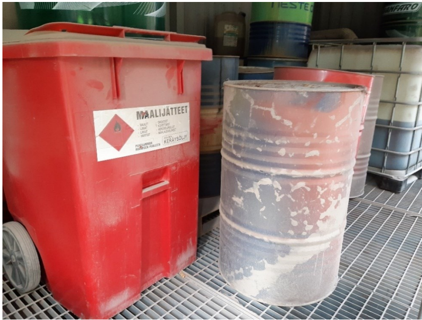
KUVA 11. Jäteöljyjen ym. muiden nesteiden oikeaoppinen varastointitapa valuma-altaiden päälle (Mutanen, 2020).
