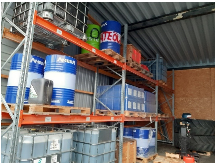
KUVA 10. Öljyjen ja muiden vaarallisten aineiden väärä varastointitapa ilman valuma-altaita (Mutanen, 2020).
