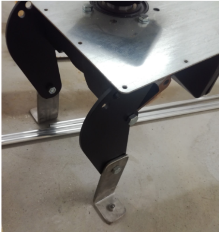
Figur 36. Förlängningsben på vinkelväxeln
