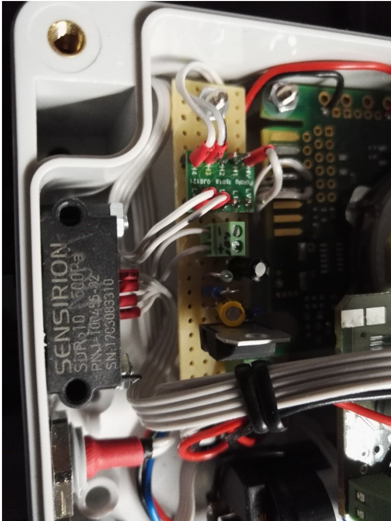
Kuva 11. Regulaattoripiirin ja logiikkamuuntimen sijoitus kotelossa.
