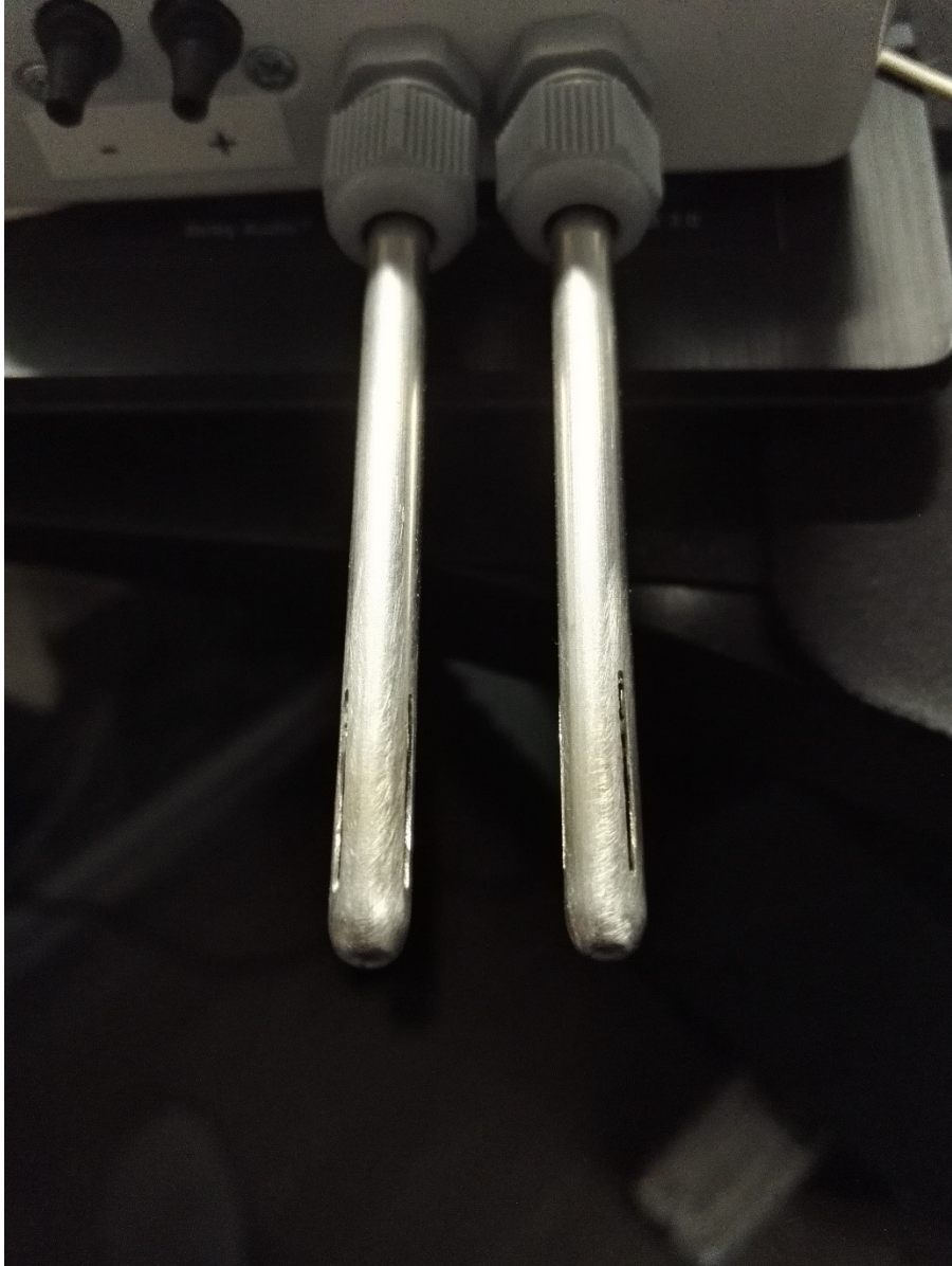
Kuva 10. Anturikortin kotelointi metalliputkessa.
