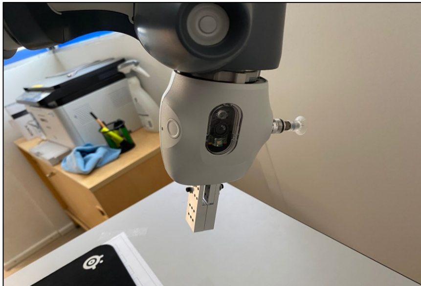
Kuva 17. Konenäkökamera integroituna robotin tarttujaan.
